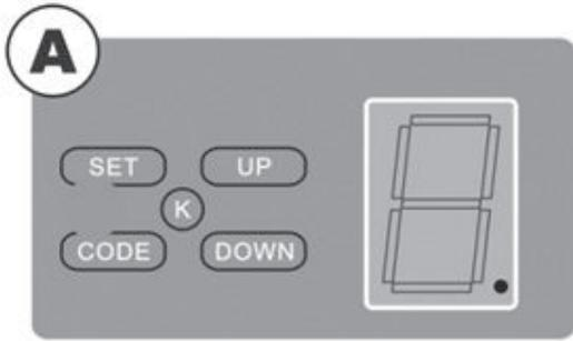
Drücken Sie die Code-Taste (1), die sich auf den Außendisplay befindet, solange bis der LED-Punkt (2) leuchtet.
