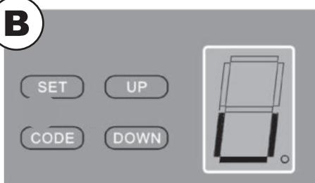
Zum Löschen aller Codes drücken Sie die CODE-Taste am Gerät ca. 8 Sekunden, bis das LED Display „C“ anzeigt.
