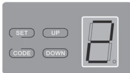
Es wird nun „2“ im Display angezeigt. Jetzt stellen Sie die untere Torposition ein indem Sie die DOWN-Taste drücken. Ca. 10cm vor Erreichen der unteren Torposition die DOWN-Taste loslassen. Nun durch mehrmaliges kurzes Drücken der DOWN-Taste das Tor in die gewünschte untere Torposition bringen und den Vorgang durch Drücken der SET-Taste abschließen.
