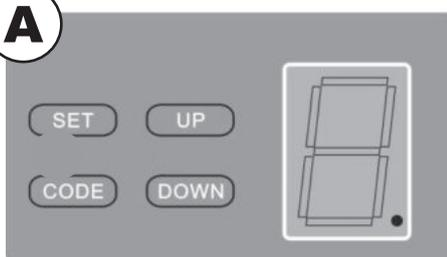
Drücken Sie die CODE-Taste solange, bis der LED Punkt leuchtet (Abb. A) Jetzt drücken Sie eine beliebige Taste auf Ihrem Handsender. Der LED Punkt erlischt. Drücken Sie die Taste auf dem Handsender erneut. Der LED Punkt blinkt jetzt schnell und das LED Display zeigt „ii“ (Abb. B).
