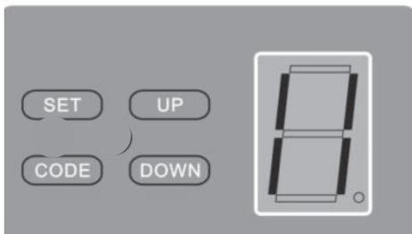
Drücken Sie die DOWN-Taste, bis die LED „II“ anzeigt. Drücken Sie die UP-Taste, um die Lichtschrankenfunktion zu aktivieren. Die LED zeigt „H“. Zum Deaktivieren drücken Sie die DOWN-Taste. Die LED zeigt „II“. Zum Bestätigen drücken Sie die SET-Taste. Schließen Sie die Lichtschranke an, wie in Abb. 11 beschrieben.
