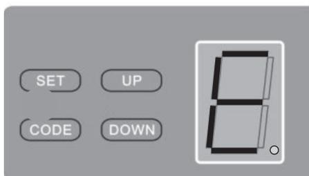
Sollte der Torantrieb keine selbstständige Lernfahrt durchführen so wird im Display ein „E“ angezeigt. Die untere Torposition ist falsch eingestellt. Das Tor drückt zu stark auf den Boden, die Schließkraft des Tores ist zu hoch.
