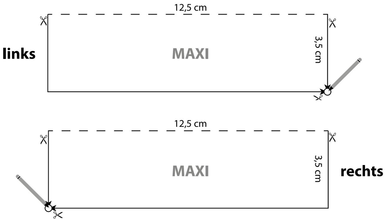
Anlage der Bohrschablone auf die Endleiste:
