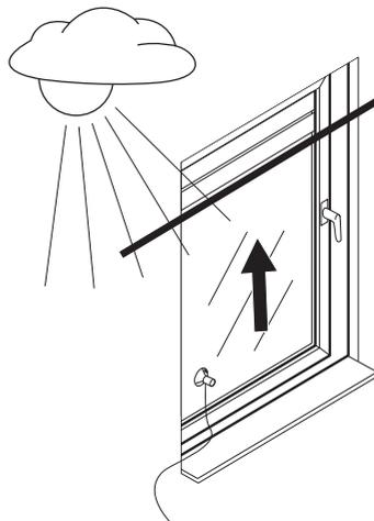
Wird die eingestellte Helligkeit ca. 10 Minuten ununterbrochen erkannt, fährt der Rollladen bis zur Position des Sensors nach unten. Nach ca. 20 Minuten wird der Rollladen ein Stück hochgezogen und der Saugknopf ist freigegeben und misst erneut.
