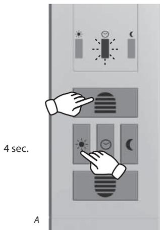
Durch das Drücken der beiden Tasten wird das Produkt in den Programmiermodus versetzt. Ab diesem Zeitpunkt muss innerhalb 10 Sekunden der Funk-Handsender gekoppelt werden (Schritte 60 bis 63). Sind 10 Sekunden vergangen, ohne den Funk-Handsender zu koppeln, muss das Produkt durch das Wiederholen des Schrittes 61 erneut in den Programmiermodus versetzt werden.
