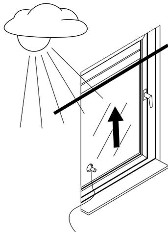
Wird die eingestellte Helligkeit ca. 10 Minuten ununterbrochen erkannt, fährt der Rollladen bis zum Saugknopf des Sonnensensors nach unten. Nach ca. 20 Minuten wird der Rollladen ein Stück hochgezogen und der Lichtsensor ist freigegeben.
