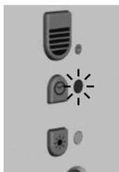
LED-Anzeige blinkt nach Stromausfall. Die gesetzte Öffnungs- und Schließzeit sollte neu eingestellt werden. Die Uhr bleibt bei Stromausfall stehen. Die anschließende Ungenauigkeit ist von der Netzausfallzeit abhängig.
