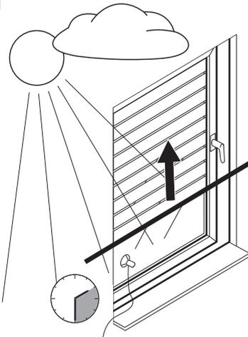
Nach ca. 20 Minuten fährt der Rollladen ein Stück über den Sensor, der erneut die Helligkeit misst.
