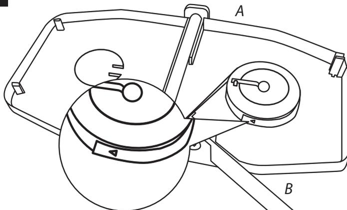
Gurtband an dem Haken der Trommel befestigen.
