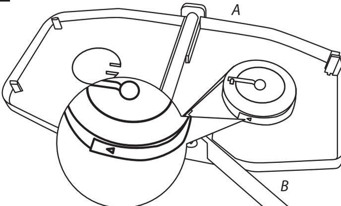
Gurtband an dem Haken der Trommel befestigen.
