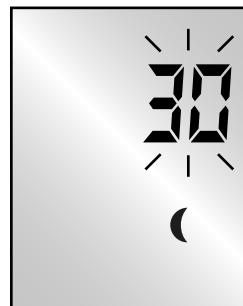
Der gewünschte Zeitversatz der automatischen Abfahrtzeit kann in 10-Minuten Schritten eingestellt werden. Hier: 30 Minuten nach Eintritt der aktuellen Astrozeit.
