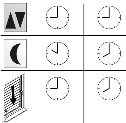
Bei eingestelltem Tages- oder Wochenprogramm und aktiverter Dämmerungs- oder Astrofunktion fährt der Rollladen zum zuerst zutreffenden Ereignis herunter.
