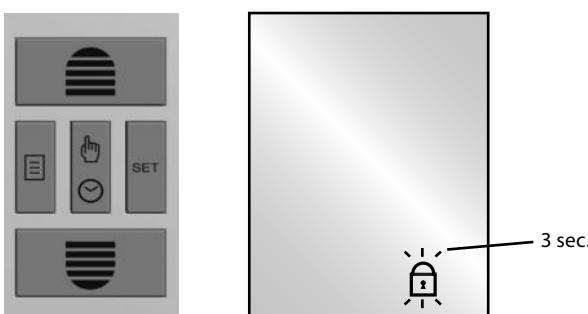
Die Tastensperre ist nun aktiv. Der Rollladen kann manuell betätigt werden.
