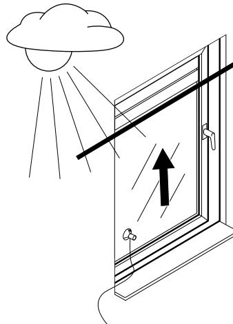
Wird die eingestellte Helligkeit ca. 10 Minuten ununterbrochen erkannt, fährt der Rollladen bis zum Saugknopf des Sonnensensors nach unten. Nach ca. 20 Minuten wird der Rollladen ein Stück hochgezogen, der Sonnensensor ist freigegeben und misst erneut.
