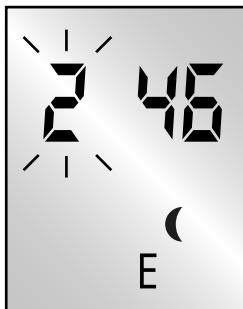
Die Astrofunktion berücksichtigt den standortbezogenen Sonnenuntergang und fährt den Rollladen bei Dämmerung im Jahresverlauf herab.
