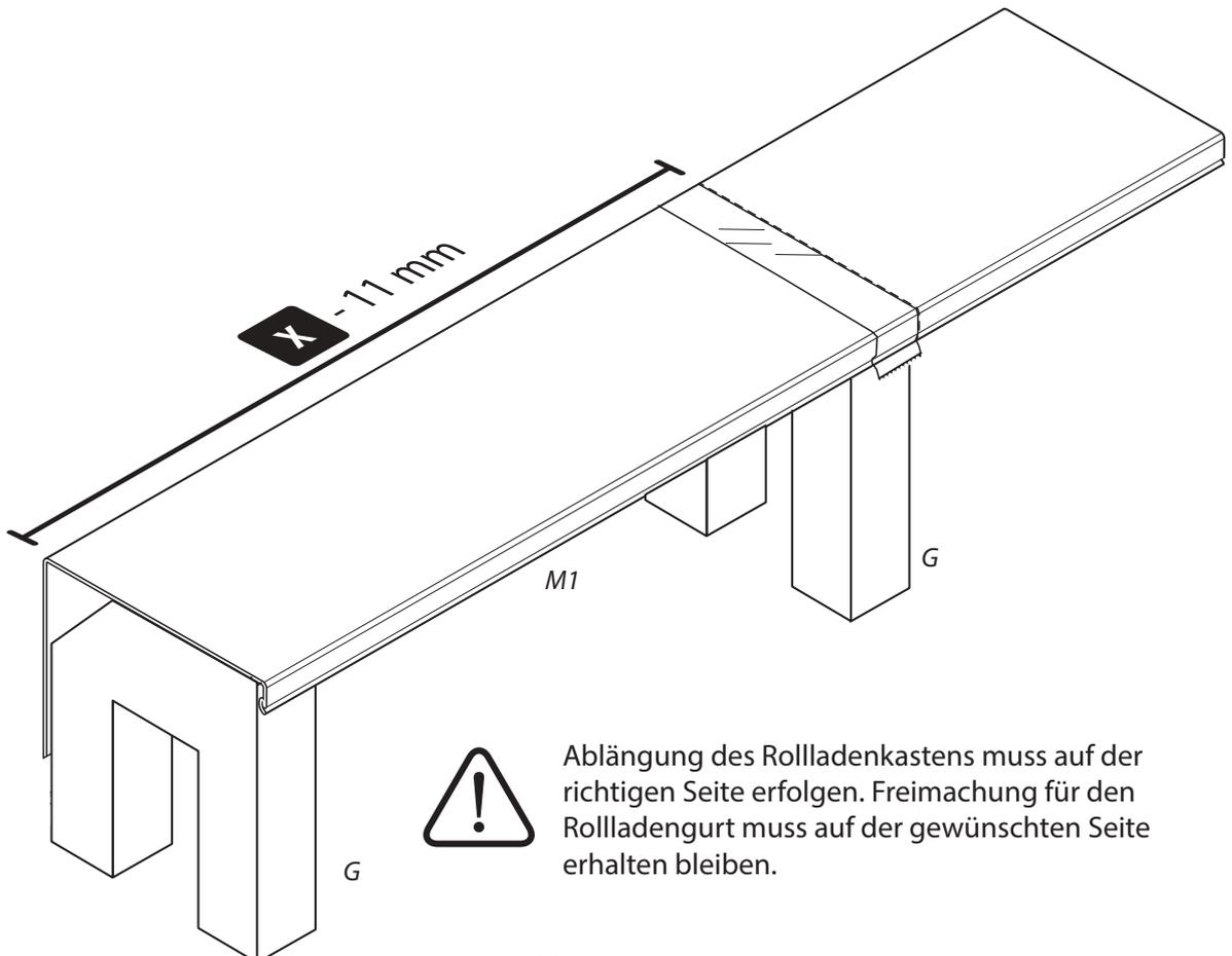
Ablängung des Rolladenkastens muss auf der richtigen Seite erfolgen. Freimachung für den Rollladengurt muss auf der gewünschten Seite erhalten bleiben.
