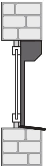
Die Fensterrahmen- bzw. Türenrahmenbreite muss für die Führungsschiene auf der Außenseite mindestens 53 mm und zur Montage des Gurtwicklers auf der Griff-Innenseite mindestens 25 mm betragen.
