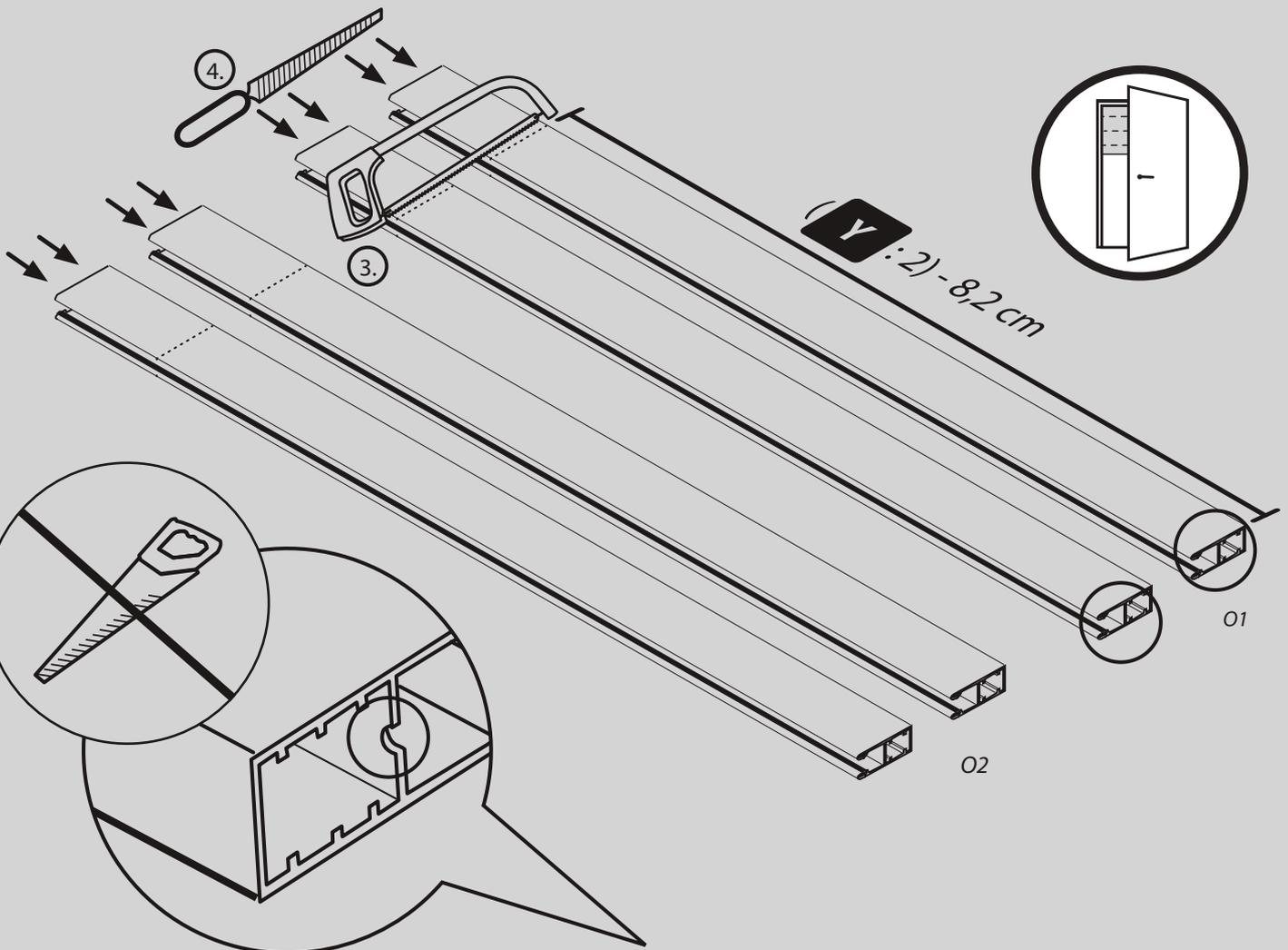
Sägen Sie bei der Führungsschiene 01 nicht auf der Seite mit der vorhandenen Einkerbung! Diese wird unbedingt benötigt um die Führungsschienen zu verbinden!
