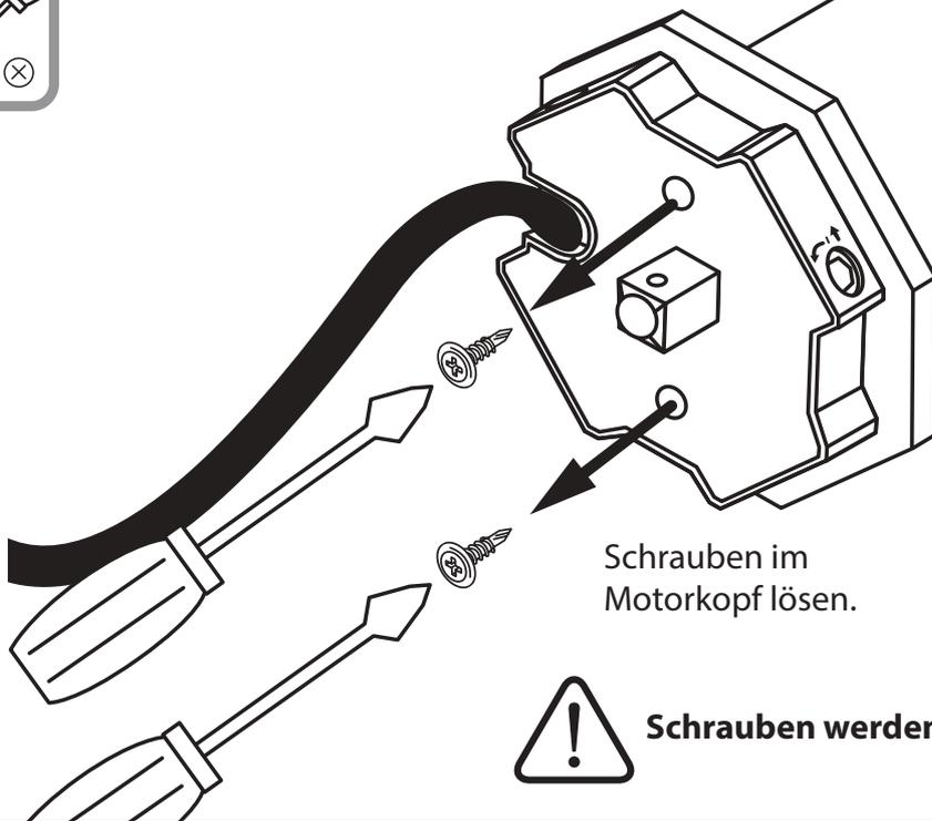
Schrauben im Motorkopf lösen.
