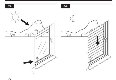
Wird der eingestellte Dämmerungswert für ca. 15 Sekunden erkannt, blinkt die LED und der Rollladen fährt in die untere Endlage. Nach der Abfahrt wird die Dämmerungsfunktion erst nach 19 Stunden wieder aktiv.
