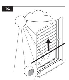
Nach ca. 20 Minuten fährt der Rollladen ein Stück über den Sensor, der erneut die Helligkeit misst.
