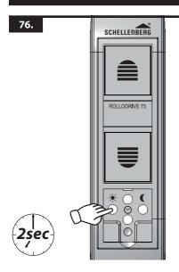
Durch Drücken der Taste Sonne wird die Sonnenfunktion ein- oder ausgeschaltet:
