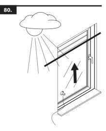
Wird der Grenzwert unterschritten, fährt der Rollladen bis zur oberen Endlage.
