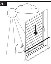
Wird der Grenzwert weitere 5 Minuten überschritten, fährt der Rollladen bis zur Position des Sensors herunter.
